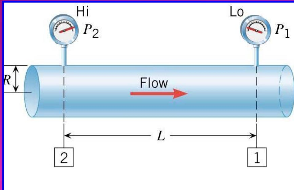
Protok **I** viskoznog fluida kroz cijev kružnog presjeka ovisi o poluprečniku cijevi **r**, Dužini cijevi **L**, razlici pritisaka (**p<sub>2</sub>-p<sub>1</sub>**) na krajevima cijevi i o koef. viskoznosti fluida **η**
