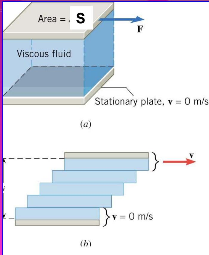
➤ Brzina slojeva je različita i jednoliko se mijenja od  $v$  do nule- Laminarno strujanje fluida.
